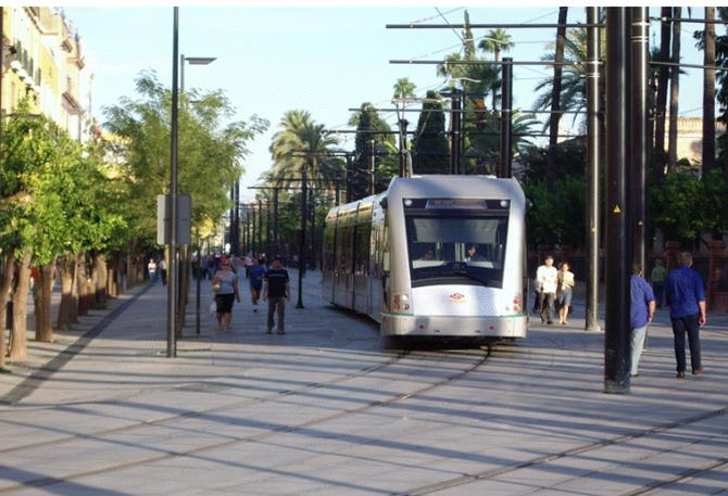
Vehículos multiarticulados compuestos de 5 módulos (permite ampliar la longitud acoplando nuevos módulos). Tienen una longitud entre testeros de 31,26 m. La tensión de alimentación es de 750 Vcc, y la potencia total del vehículo es de 560 kw (8 x 70).
